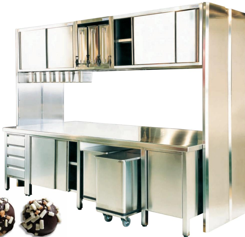
I pensili e le porta bagne realizzati completamente in acciaio inox Aisi 304 con struttura rinforzata autoportante. Possibilità di inserire piani interni a varie altezze in funzione delle asole reggipiani. Le ante scorrevoli corrono su cuscinetti gommati in alto, ed hanno una guida antispurco in basso. I pensili vengono fissati a parete mediante una fascia a baionetta a scomparsa totale.
