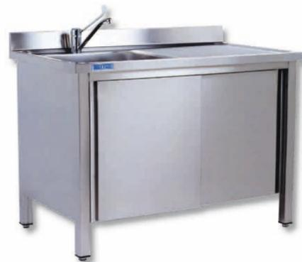
Struttura rinforzata di spessore maggiore in acciaio inox Aisi 304 18/10 scotch brite, top con alzatina paraspruzzi inclinata da 85-100 mm e vasche inclinate verso lo scarico. Versione con o senza ripiano di fondo con armadio a portine scorrevoli su cuscinetti gommati.
